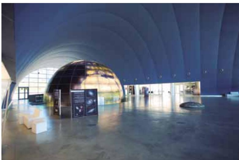
A forma troncocónica da estrutura e a esfera colocada numa posição central e afastada focalizam toda a sua atenção. O revestimento têxtil contínuo, de cor azul, faz parte desta cenografia. Inclui pontos luminosos que atravessam o tecido e que cuja forma irregular remete para os astros do universo. A tela maciça está presa no lado superior à estrutura metálica nas linhas que acompanham os arcos da estrutura principal.
